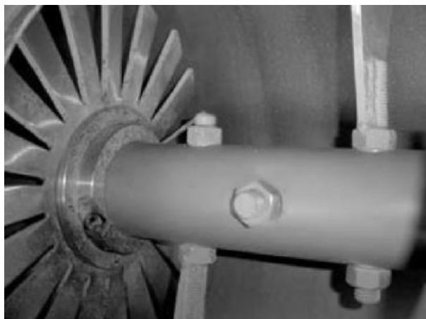
شکل ۴- صفحات نگهدارنده در انتهای مخزن کاندیشنر
